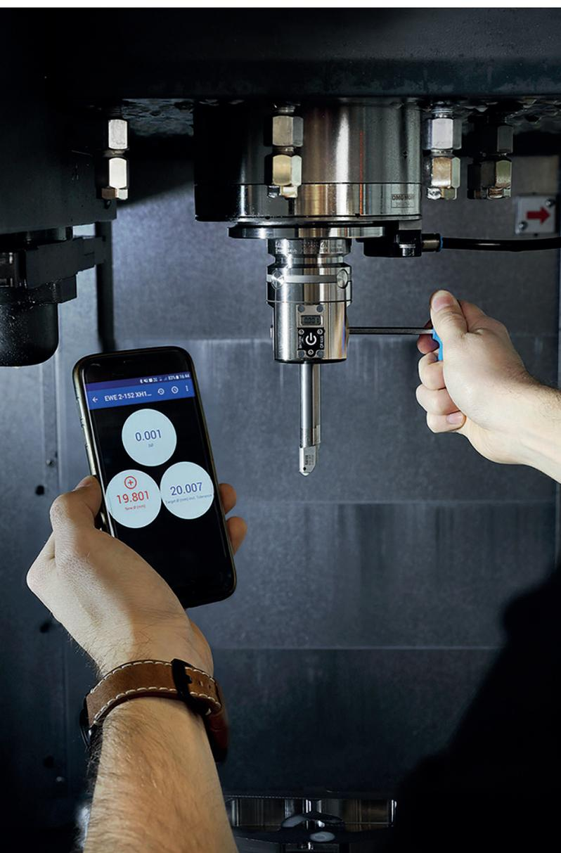
1 Wegweisend: Ein digitaler Feinbohrkopf mit Wireless-Verbindung, der seine Daten auf einen externen Bildschirm überträgt. Er wird mithilfe eines Smartphones eingestellt (© BIG Kaiser)
